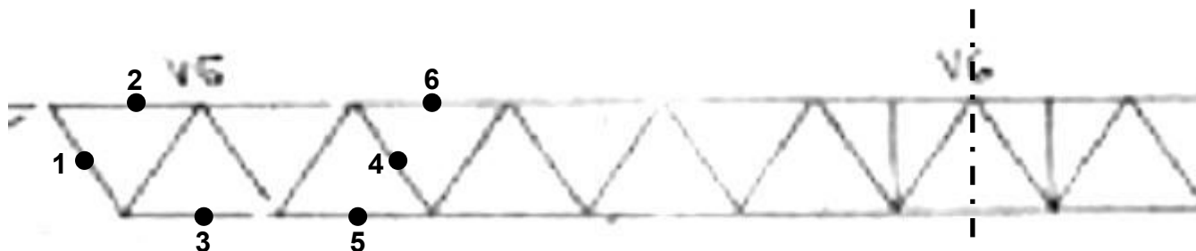
SCHÉMA č.4: Místa provedených měření a ověření profilů na vaznicích VZ1 a VZ2
